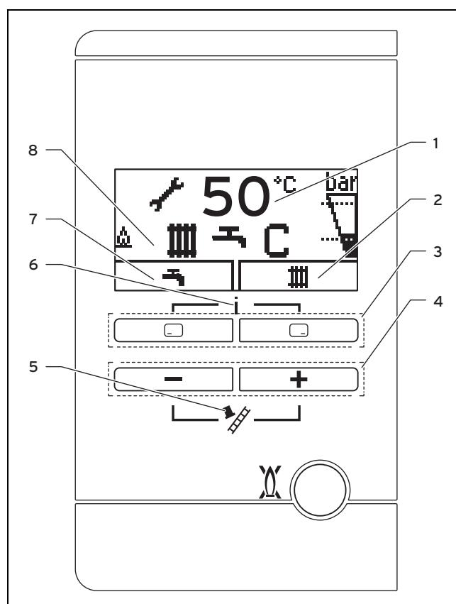
1 Température de départ du chauffage actuelle, pression de remplissage de l'installation de chauffage, mode de fonctionnement, code d'erreur ou informations complémentaires
