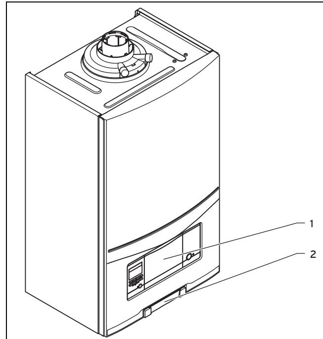
1 Éléments de commande 2 Plaque avec numéro de série à l'arrière
